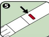
5. **Die Injektionsanzeige wird rot.** Dies zeigt an, dass die Injektion vollständig abgeschlossen ist. Wenn die Injektionsanzeige nicht rot ist, muss die Injektion mit einem neuen Anapen wiederholt werden.
