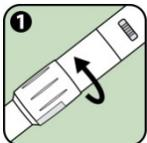
1. Die Abdeckung über dem Sichtfenster wie vom Pfeil angezeigt vollständig gegen den Uhrzeigersinn drehen, um die Linsen über dem Sichtfenster des Autoinjektors auszurichten.
