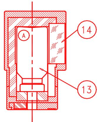
Zur Elution des Generators die Schutzkappe oder die Durchstechflasche zum Schutz der Elutionsnadel durch das Elutionsbehältnis (A) austauschen. Dieser enthält eine evakuierte Elutions-Durchstechflasche (mit der Kennzeichnung „TC-Elu“) entsprechend dem gewünschten Elutionsvolumen (13).
